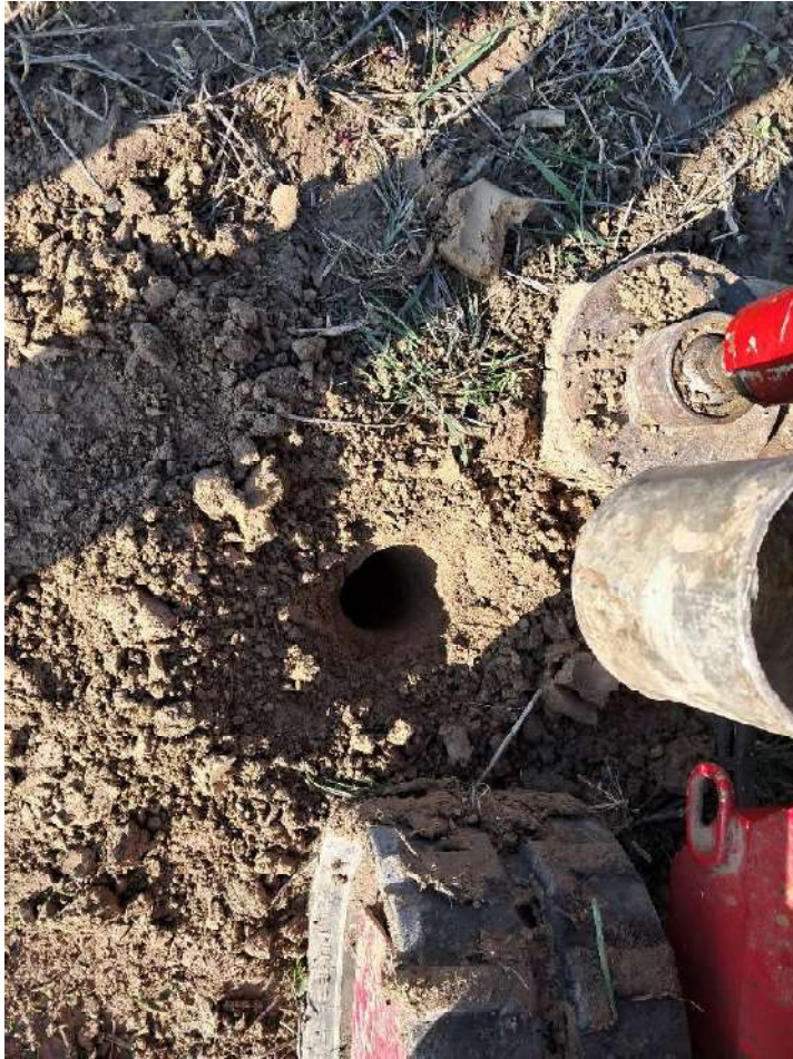
ESEMPIO DI FORO DI PRELIEVO DIAM 95 mm
