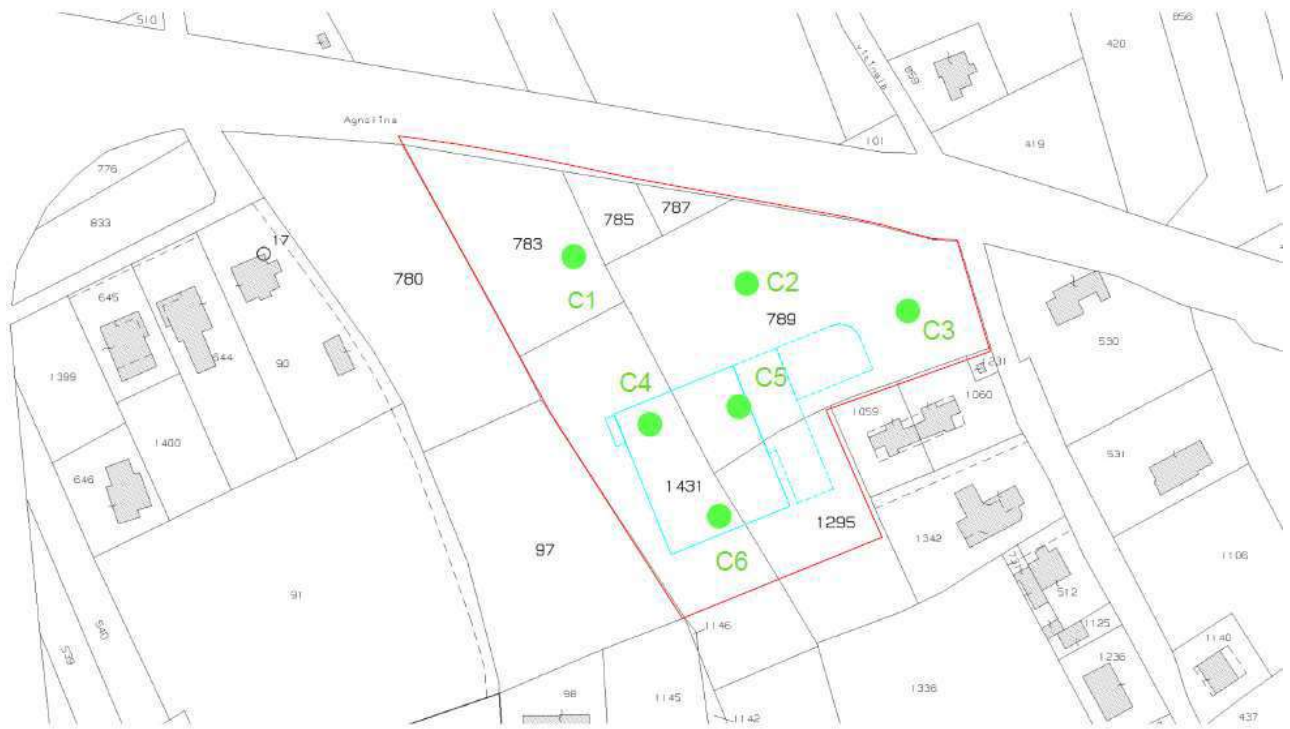
Schema base punti di prelievo per caratterizzazione suolo Scala 1:1000
