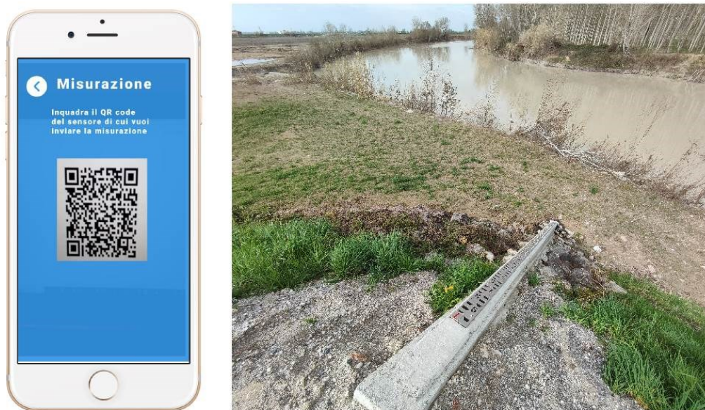
Figura 57. Esempio di una schermata della COapp (a sinistra) e fotografia dell'asta idrometrica posta a valle dell'incile del canale Cavrato (a destra).
