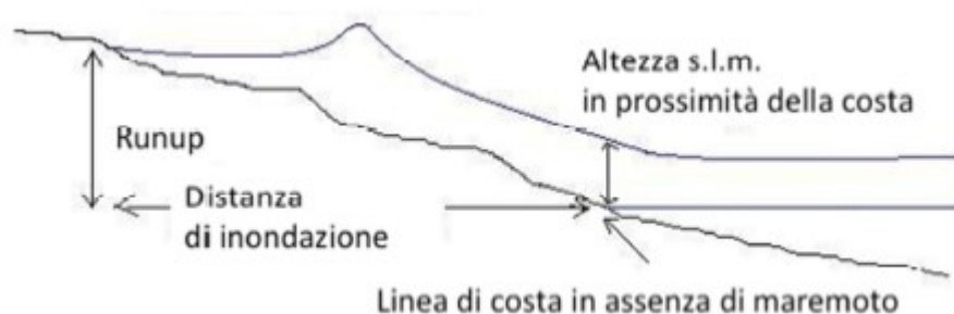
Figura 71: Schema esemplificativo del concetto di run-up (Fonte: Indicazioni per l'aggiornamento delle pianificazioni di protezione civile per il rischio maremoto – Allegato 1, 2018).
